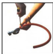
1. Załóż opaskę na wąż i dokręć za pomocą śrubokręta.
